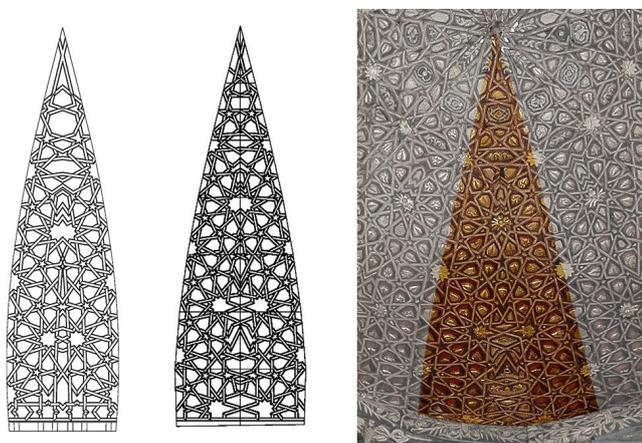
Figura 15. Aproximaciones gráficas al trazado de un gajo (izquierda y centro), y fotografía del intradós en la que se destaca en color un gajo (derecha).
