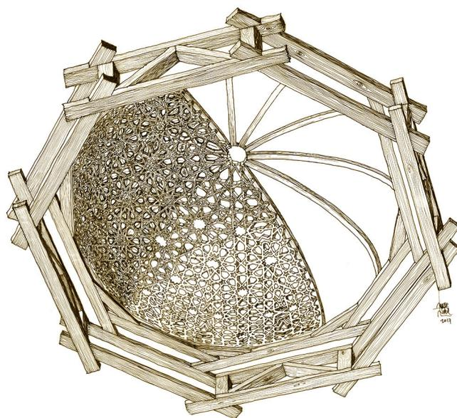
Figura 13. Vista inferior de la cúpula, en diferentes fases del proceso de montaje de los gajos sobre los camones principales.
