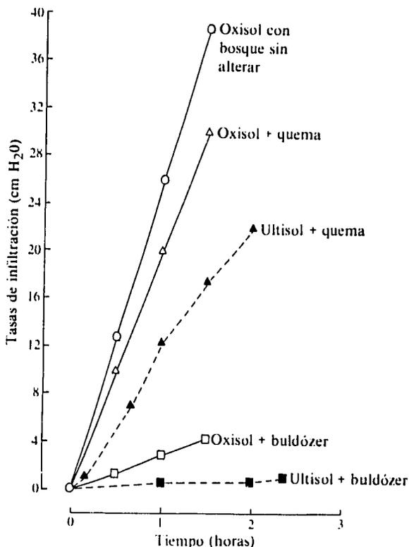
Figura 4. Efecto del método de desmonte en las tasas de infiltración de dos suelos de la Amazonia.
