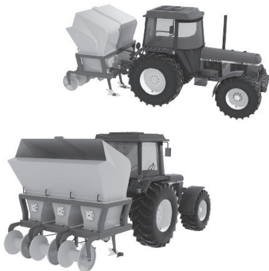
La biofumigadora enganchada al tractor
