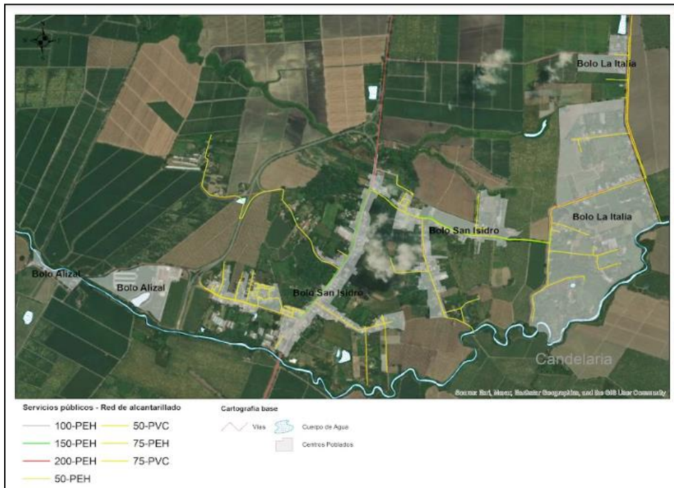
Imagen 14. Bolo Alizal, B. La Italia y B. San Isidro / ALCANTARILLADO. Fuente: Elaboración propia, 2022
