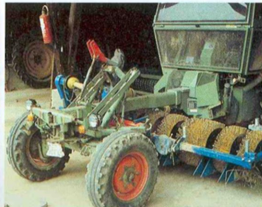
Slika 44 i 45. Četkaste kultivatore moguće je smjestiti ispod ili iza traktorske kabine
