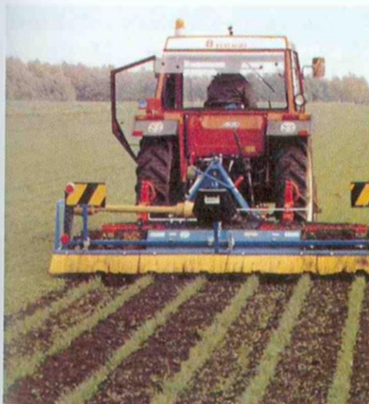
Slika 44 i 45. Četkaste kultivatore moguće je smjestiti ispod ili iza traktorske kabine
