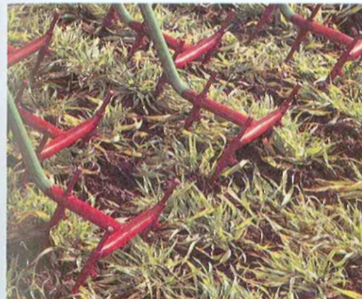
Slika 42. Modifikacija »drljača-češljeva«, prikladna i za teža tla
