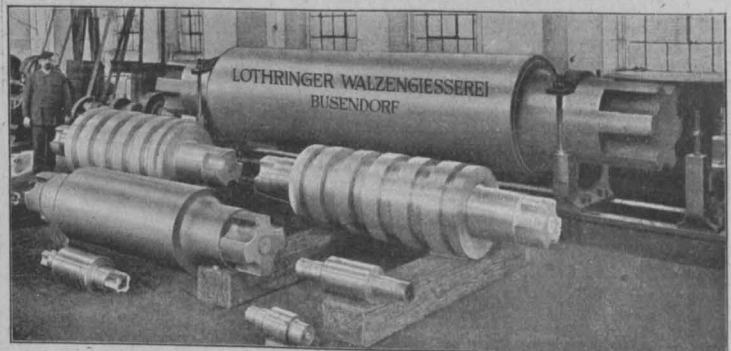
Abb. 5. Gußeiserne Walzen mit Gußspänebrikettzusatz gegossen.
