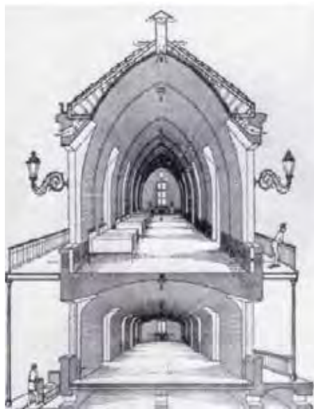
Figura 6: Sistema Tollet. Esquema de un pabellón hospitalario. Imagen de dominio público.
