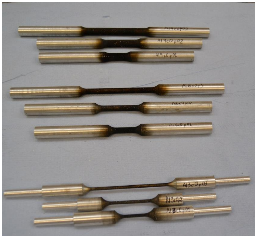
Figura 3.1 – Probetas ensayadas de distintos diámetros y de diferentes longitudes. Fotografía de las nueve probetas
