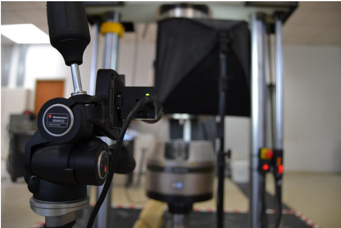
Figura 3.8 – Montaje del ensayo de tracción con medición de deformaciones mediante extensometría óptica.
