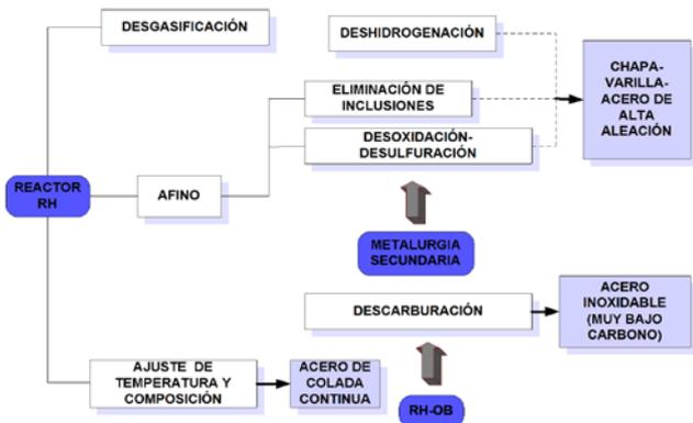
FIGURA 21 PROCESOS METALÚRGICOS QUE PUEDEN UTILIZAR REACTOR RH
