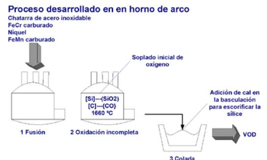
FIGURA 13 ETAPAS EN EL HORNO DE ARCO ANTES DEL PROCESO VOD
