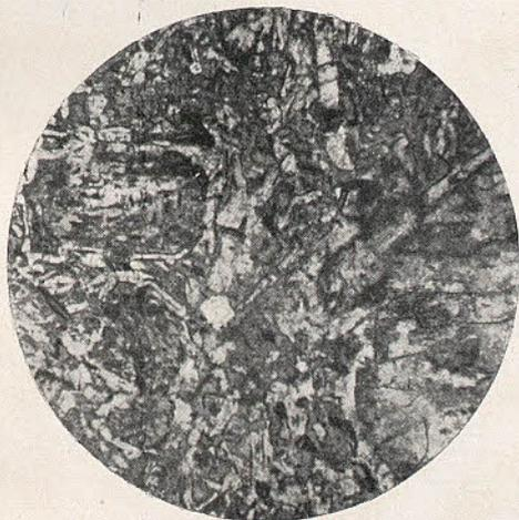
Fig. 7. — Diabasa porfídica de la Sierra de Córdoba, Dehesa de Tres Puentes, prep. n.º 347 col. Mº de Barcelona. L. ord. 20 d. 3 labrador, 6 dialaga uralitizando, 11 ilmenita. Microfot. M. San Miguel.
