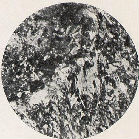
Fig 6. — Epidiorita (diabasa actinótica) de la Sierra de Córdoba, Dehesa de Tres Puentes, prep. n.º 349 col. Mº de Barcelona. N + 40 d. 2 feldspato alterado, 5 actinota, 10 epidota en vías de formación-zoisita. Microfot. M. San Miguel.
