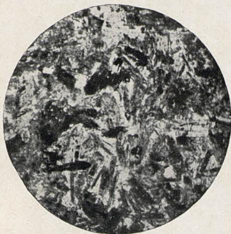
Fig. 1. — Kersantita de la Sierra de Córdoba, Dehesa de Tres Puentes, prep. n.º 344 col. Mº de Barcelona. L. ord. 40 d. 1 cuarzo, 2 feldespato alterado, 4 biotita, 11 magnetita. Microfot. M. San Miguel.
