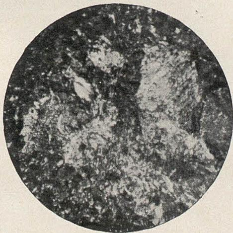
Fig. 10. — Orto-anfibolita feldespática de la Sierra de Córdoba, Dehesa de Tres Puentes, prep. n.º 348 col. Mº de Barcelona. N + 40 d. 2 feldespato alterado, 5 actinota. Microfot. M. San Miguel.
