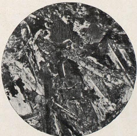
Fig. 4. — Diabasa uralítica de la Sierra de Córdoba, Dehesa de Tres Puentes, prep. n.º 346 col. Mº de Barcelona. N + 40 d. 3 labrador, 6 augita dialógica, 9 uralita, 11 ilmenita. Microfot. M. San Miguel.
