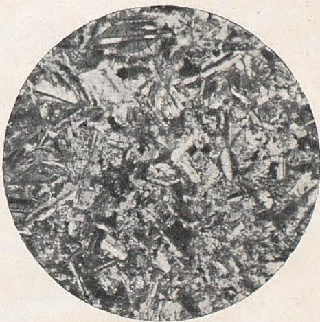
Fig. 8. — Diabasa porfídica de la Sierra de Córdoba, Dehesa de Tres Puentes, prep. n.º 347 col. Mº de Barcelona. N + 40 d. 3 labrador, 6 dialaga, 11 ilmenita. Microfot. M. San Miguel.
