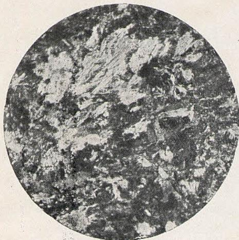
Fig 5 - Epidiorita (diabasa actinótica) de la Sierra de Córdoba, Dehesa de Tres Puentes, prep. n.º 349 col. Mº de Barcelona. N + 40 d. 2 plagioclasa, 5 actinota, 11 magnetita. Microfot. M. San Miguel.
