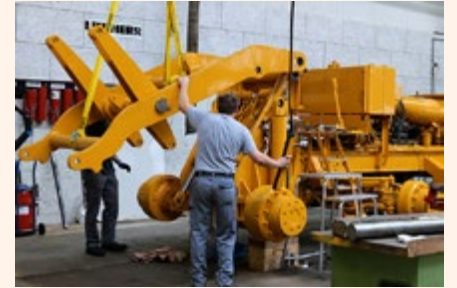
Expertos en palas cargadoras trabajando: el brazo de elevación restaurado está montado en el taller.
