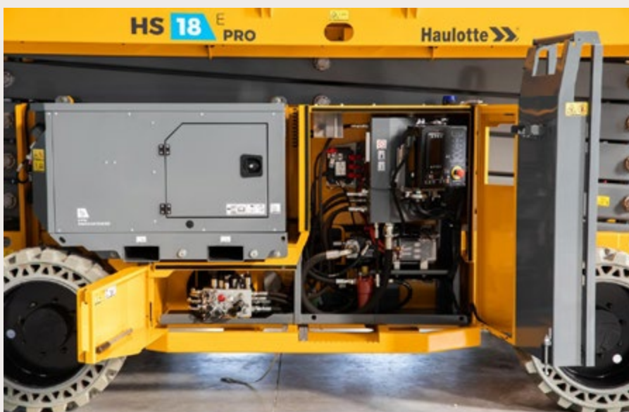
Las nuevas tijeras PULSEO ofrecen acceso directo a componentes hidráulicos y eléctricos
