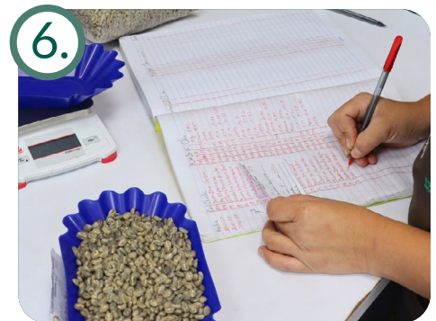
6. Factor de rendimiento: El resultado del paso 5 (gramos de café seleccionado) debe ser dividido entre 250 gramos y multiplicado por 100, esto nos dará el % de rendimiento de la muestra
