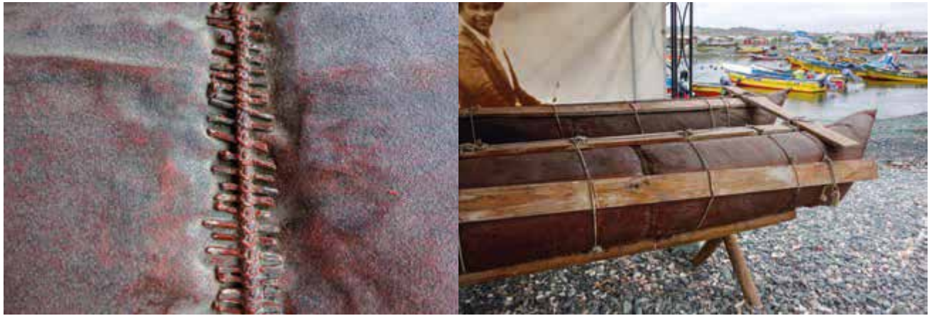
Replica de balsa de cuero de lobo marino usada por los pueblos originarios de la costa de la Región de Atacama y detalle de la costura del cuero realizada con tripas y espinas de cactus. Foto: Jorge Herreros.
