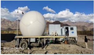
Fig. 36. Portable X-Band Doppler Weather Radar
