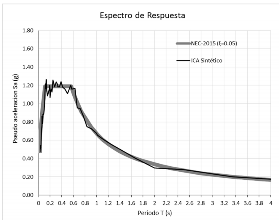
Figura VI-9: Espectro de Respuesta para registro ICA artificial
