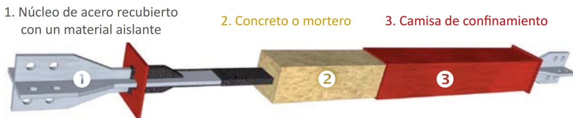
Figura I-7: Componentes básicos de un BRB [Fuente: (Cancelado, 2013)]
