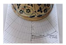
**Figura 10.** Medición del diámetro de la base. Sobre la plantilla de diámetros.
