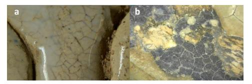
Figura 32. Craqueladuras en el esmalte original (a) craqueladuras en zona reintegrada (b).
