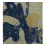
**Figura 29.** Delaminación de la capa de esmalte.
