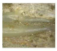
**Figura 27.** Detalle con microscopio USB Dino-lite adhesivo unión de fragmentos.
