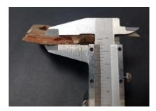
**Figura 11.** Pie de rey durante la medición del grosor de uno de los fragmentos.
