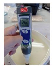
Figura 38. Detalle valor del conductímetro tras 24horas con el fragmento inmerso en agua desionizada.
