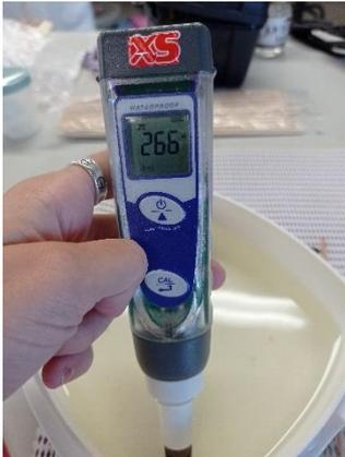
Figura 38. Detalle valor del conductímetro tras 24 horas con el fragmento inmerso en agua desionizada.
