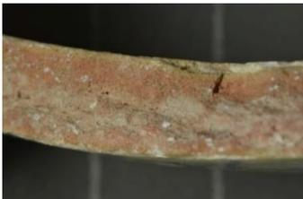
Figura 7. Detalle sección del bizcocho.
