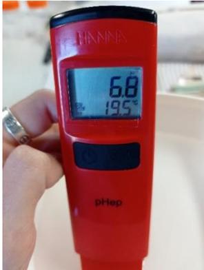
Figura 40. Valor de pH de la pieza.
