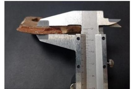
Figura 11. Pie de rey durante la medición del grosor de uno de los fragmentos del objeto.
