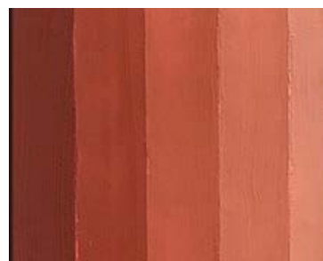
Figura 23. Gradaciones del rojo de óxido férrico con la adición de blanco de plomo.
