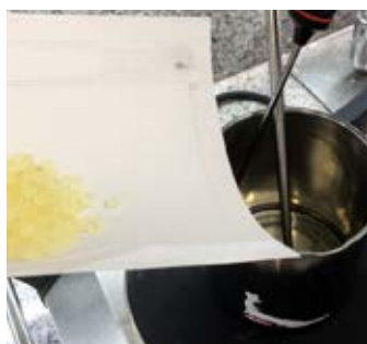
Figura 5. Adición de la resina mastic.
