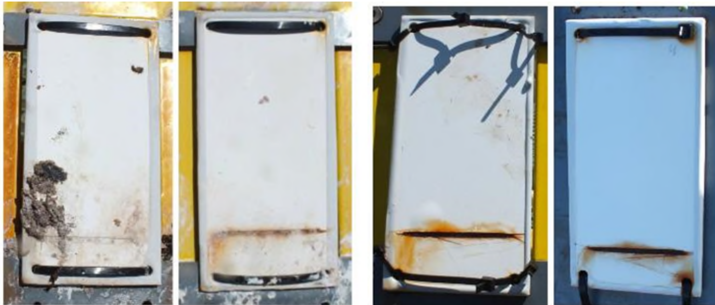
Figura 12. Aspecto de las probetas N° 1 y 2 tras 6 meses de exposición en zona atmosférica. Figura 13. Aspecto de las probetas N° 3 y 4 tras 6 meses de exposición en zona splash.
