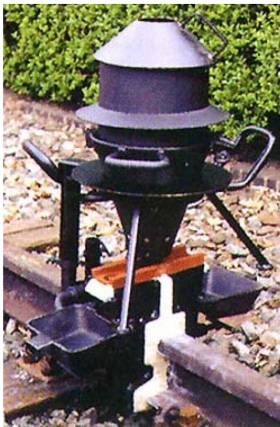
**Fig. 7. O sistema de cadinho para soldagem de trilhos.
