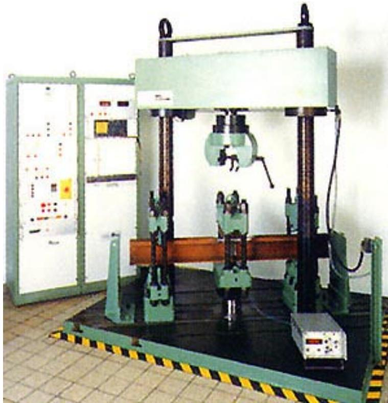
**Fig. 15. Teste de fadiga em soldas Thermit®.
