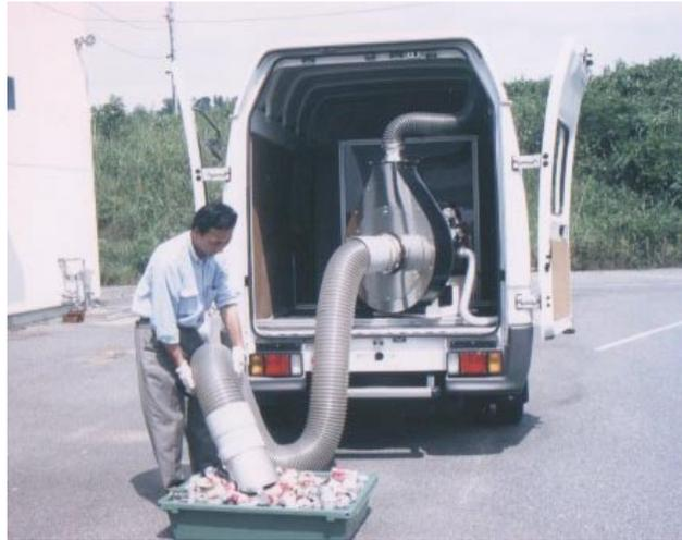
**Fig. 12. A mangueira recolhe as latas amontoadas.
