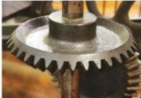
$i = \frac{n_1}{n_2} = \frac{Z_2}{Z_1}$ | <p><b>Ventajas</b></p> <ul style="list-style-type: none"> <li>• La transmisión de potencia es precisa, suave, uniforme y segura.</li> <li>• Se trata de un sistema reversible.</li> </ul> <p><b>Inconvenientes</b></p> <ul style="list-style-type: none"> <li>• Necesita lubricación.</li> <li>• Su coste es elevado.</li> <li>• Rueda y piñón no son intercambiables.</li> </ul> |
