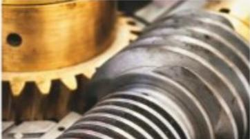
$i = \frac{n_1}{n_2} = \frac{Z_2}{e} \quad e: \text{número de entradas del tornillo}$ | <p><b>Ventajas</b></p> <ul style="list-style-type: none"> <li>• La transmisión de potencia es suave, uniforme, silenciosa y segura.</li> <li>• Los ejes forman un ángulo de 90°.</li> <li>• Se trata de un sistema no reversible.</li> </ul> <p><b>Inconvenientes</b></p> <ul style="list-style-type: none"> <li>• Necesita lubricación.</li> <li>• Su coste es elevado.</li> </ul> |
