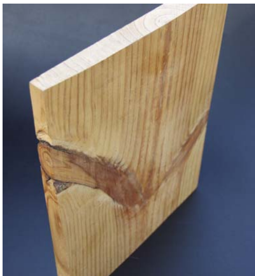
Detalle de las ramas que salen de la medula e incluso de la parte de rama que ya muerta en el momento de ser englobada en el tronco da lugar a un nudo saltadizo
