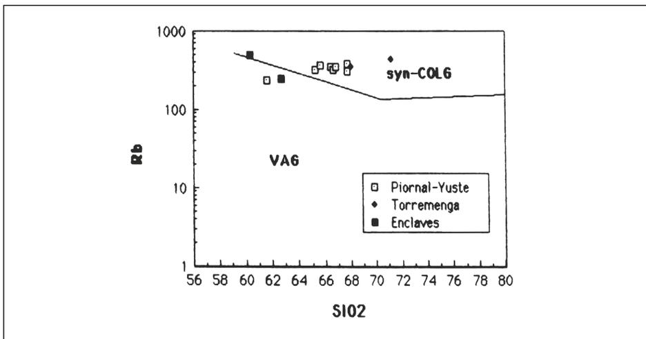
Figura 5.10. SiO<sub>2</sub> – Rb como discriminante entre granitos de arco volcánico y sin-colisionales (según Pearce *et al.*, 1984).
