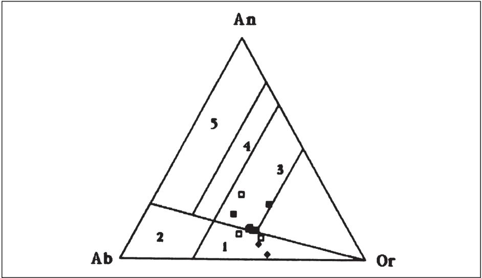
Figura 5.4. Diagrama An-Ab-Or. 1 = granito, 2 = trondhjemitita, 3 = adamellitita, 4 = granodiorita y 5 = tonalita (según O'Connor, 1965). Leyenda como en la Figura 5.8.
