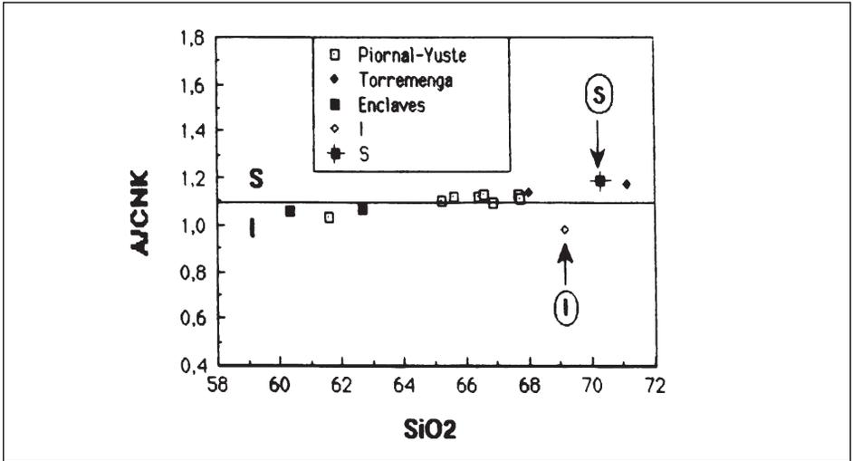
Figura 5.5. Diagrama SiO<sub>2</sub> frente a la relación (en proporciones moleculares) Al<sub>2</sub>O<sub>3</sub> / (CaO+Na<sub>2</sub>O+K<sub>2</sub>O). La línea correspondiente a A/CNK = 1.1. separa los campos correspondientes a granitos I y S. Los puntos marcados con flechas rellenas corresponden a muestras representativas de granitos tipos I y S respectivamente (según Whalen et al., 1987).
