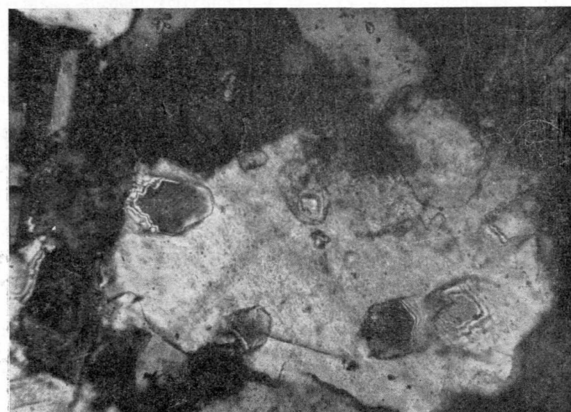
Fig. 2.—Desalajamiento por cuarzo e inversión del desalajamiento por la roca madre. a) Arriba: Isleo, calizo, recrecido de cristales de cuarzos de neoformación, en su mayor parte xenomorfos, reunidos en una textura cuarcítica. Insertos en la caliza y englobados en ella cuarzos de delimitación idiomorfa. Gorno, Alpes italianos (límite Ladin/Karn). Según R. Vaché. Lámina delgada, nicóles X. 110 X. b) Abajo: Cuarzos idiomorfos de neoformación en calizas débilmente margosas (límite Ladin/Karn). Cristales de cuarzo parcialmente desalajados por calcita (rebordes calcíticos) o desalajados enteramente (rosetas de calcita). Gorno, Alpes italianos. Según R. Vaché. Lámina delgada, nicóles X. 220 X.
