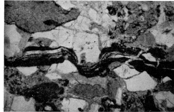
Foto 8.—Pequeña banda de estructura fluidal en el microconglomerado del kilómetro 20. Arriba y en el centro un cristal de ortosa alterado a clorita por los bordes y según algunas fisuras.—L N. 34 D.
