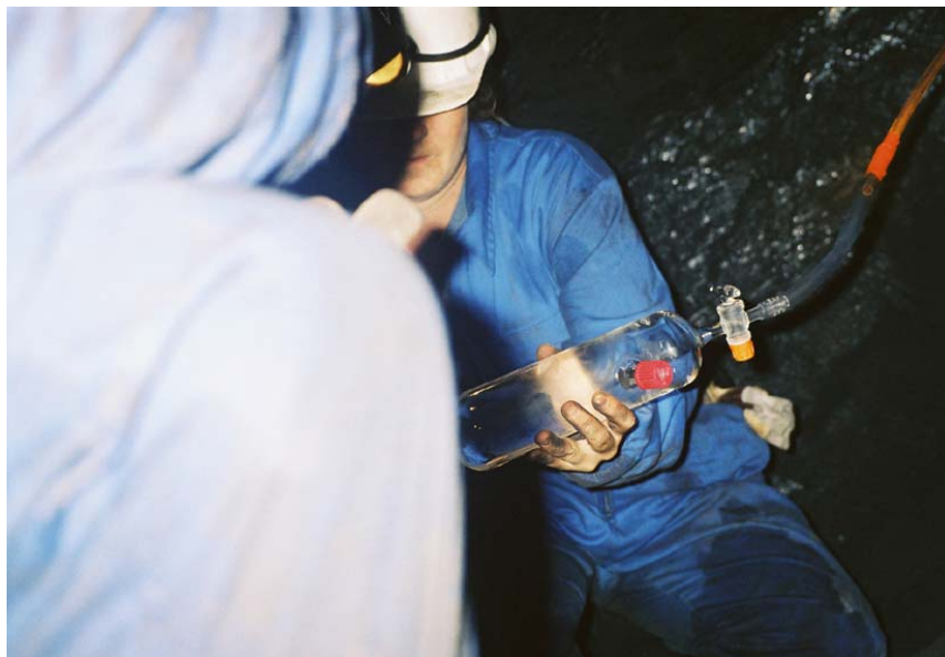
Figura 12 : Toma de muestra de gas del Pozo Peragido
