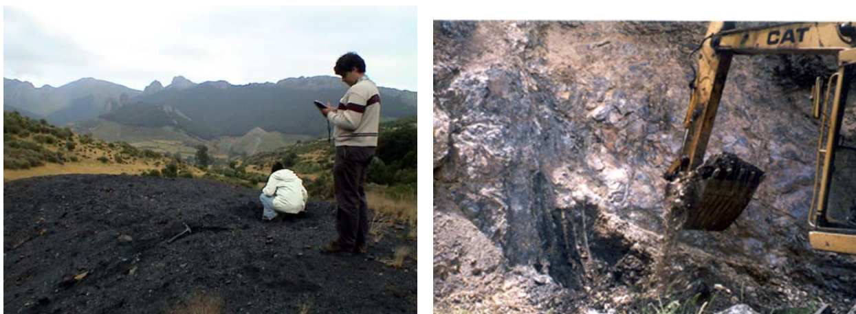
Figura 6: Recogida de muestras en escombrera y capa en afloramiento, limpiando el frente con una pala.
