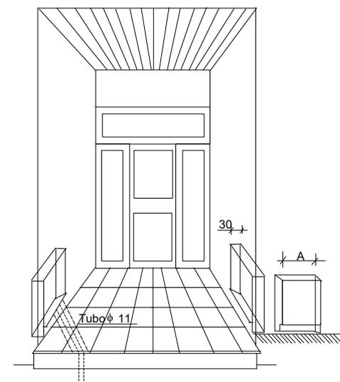
*Figura 10.a) - Montaje CGP en pared*
