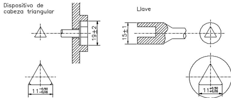
Figura 8.- Detalles de la cerradura de cabeza triangular
