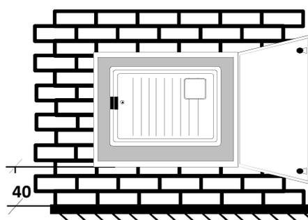
Figura 11.a) - Montaje CPM empotrada en valla      Figura 11.b) - Montaje en nicho de pared
