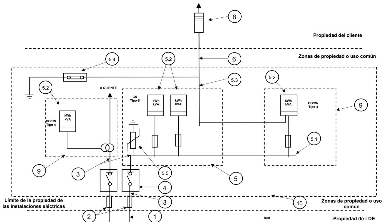
Figura 1.- Instalación de enlace, esquema unifilar.
