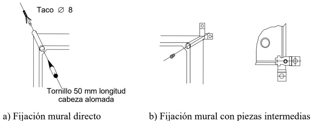
*Figura 9.- Dispositivos de fijación de CGP*
