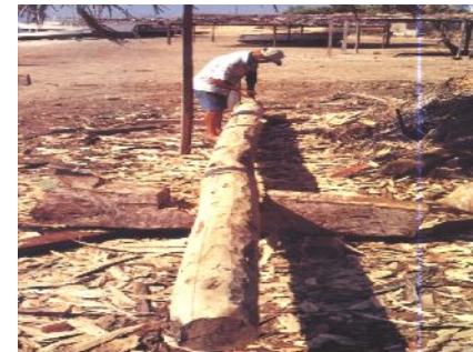
Construcción de quilla
