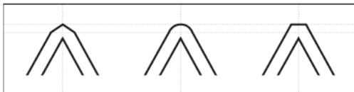
Ejemplos de unión de reventado, de izquierda a derecha: inglete, redonda y bisel
