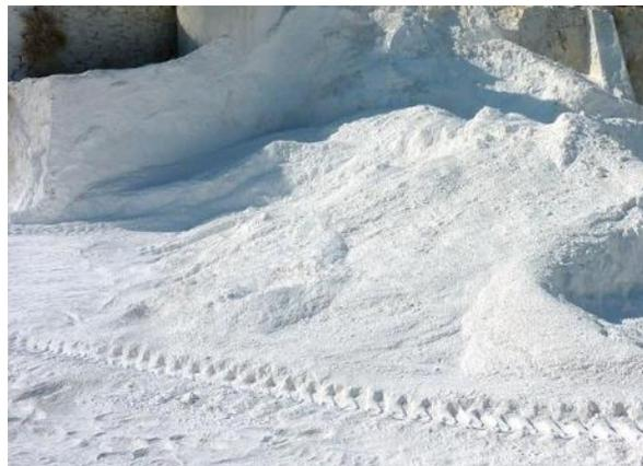
La cal es un término genérico que designa todas las formas físicas en las que pueden aparecer el óxido de calcio y el de magnesio, (CaO y MgO) y/o el hidróxido de calcio y/o el de magnesio, (Ca(OH)<sub>2</sub> y Mg(OH)<sub>2</sub>). Una clasificación general de las cales utilizadas en construcción puede ser la siguiente:
