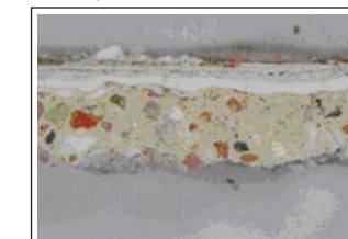
Sección transversal de la muestra mediante lupa binocular a 30X
