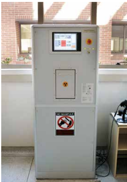
Figura 3. Irradiador de rayos gamma. Fuente: Cesio 137 BIO-BEAM Hemocentro Distrital, Bogotá D.C.
