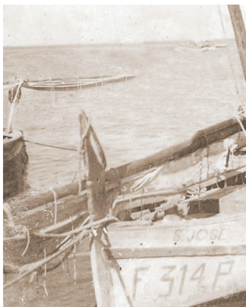
Detalle. Obsérvese el embarbaor en el car, aunque lleva el agujero o piñón de la roda.
