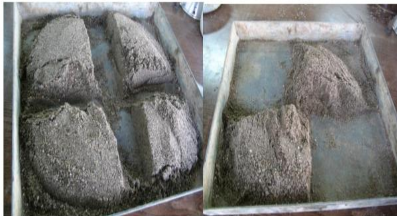
Figura 11 Cuarteo del agregado [11].
