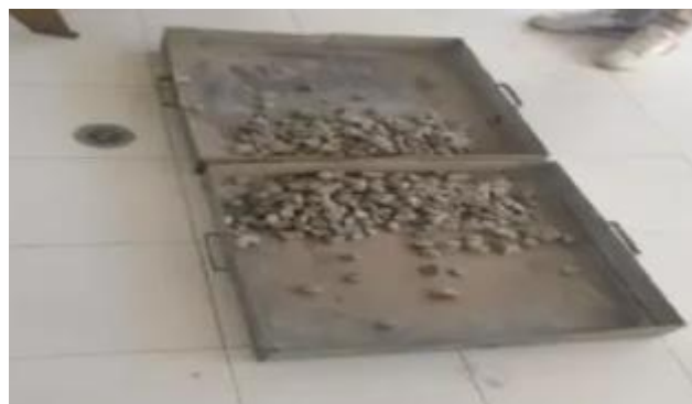
Figura 7 Obtención de muestra después del primer cuarteo [7].
