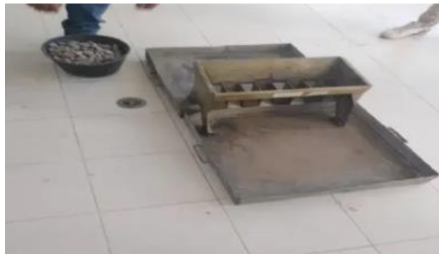
Figura 6 Cuarteador mecánico para vaciado de agregado [6].
