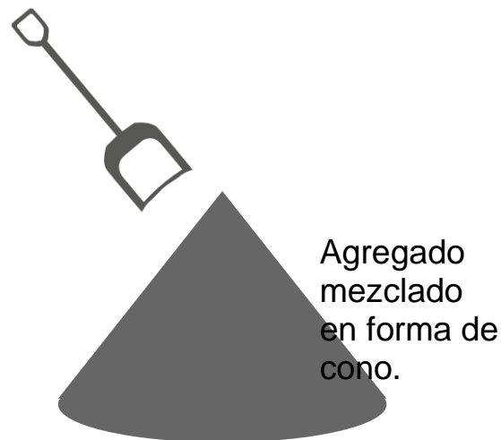
Figura 8 Agregado mezclado en forma de cono Fuente: Propia [8].
