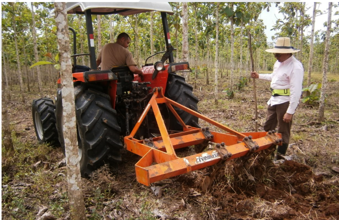
FIGURA 2. LABRANZA CON ARADO DE CINCELES EN PLANTACIONES ESTABLECIDAS DE TECTONA GRANDIS
