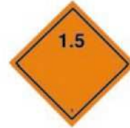
Nº 1.5 Riesgo de explosión, división 1.5
