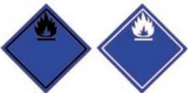
Nº 4.3 Peligro de emanación de gas inflamable al contacto con el agua
