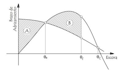
Fig. 20 - Criterio de estabilidad para remolque portuario
