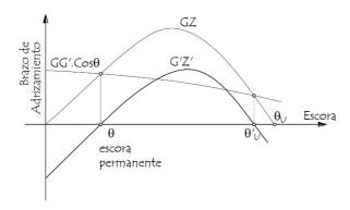
Fig. 8 - Curva de estabilidad afectada por movimiento lateral de pesos
