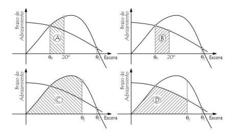
Fig. 21 - Criterio de estabilidad para remolque escolta
