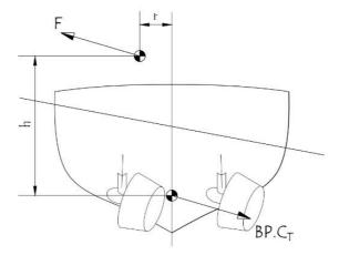
Fig. 16 - Diagrama de fuerzas durante operaciones de remolque portuario
