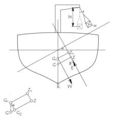
Fig. 11 - Brazo de adrizamiento afectado por pesos suspendidos
