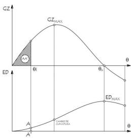
Fig. 14 - Correspondencia entre la curva de estabilidad intacta y la curva de estabilidad dinámica
