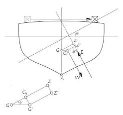
Fig. 7 - Afectación de la estabilidad por movimiento transversal de pesos
