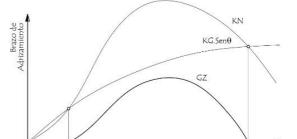
Fig. 13 - Curva de estabilidad para valores de KG muy elevados
