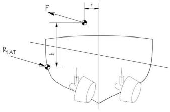
Fig. 17 - Diagrama de fuerzas durante operaciones de remolque portuario
