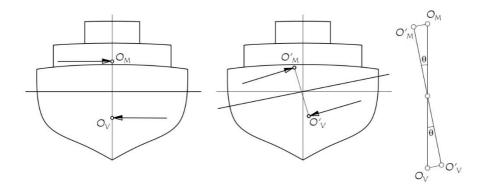
Este método considera la obra viva y la obra muerta del buque adrizado como elementos referenciales para el cálculo del momento. En la condición de equilibrio, cuando  $\theta = 0^{\circ}$ , los valores de cálculo coinciden con los valores reales del área expuesta A y la distancia Z medida entre los centroides de las proyecciones de la obra viva o plano de deriva y la obra muerta,  $O_V$  y  $O_M$  respectivamente.
