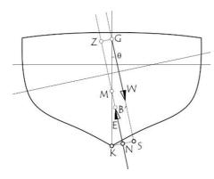
Fig. 12 - Brazo de adrizamiento afectado por posición elevada del centro de gravedad
