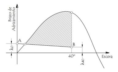
Fig. 19 - Criterio de estabilidad para buques con carga a granel
