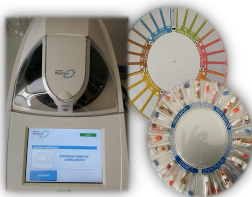
Figura 2 - Imagem do aparelho de PIM utilizado pela Farmácia (*Medical Dispenser*<sup>®</sup>) e dos respetivos discos.
