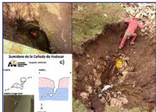
Figura 4. a) pozo excavado en las arcillas de relleno hasta acceder a la roca madre. b) Aspecto del sumidero tras las precipitaciones ocurridas en diciembre de 2022. c) topografía del sumidero en 2022.
