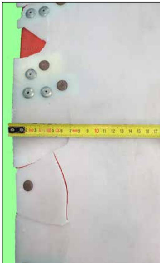
Detalle de afectación de la lámina de polietileno HDPE. Proceso avanzado.
