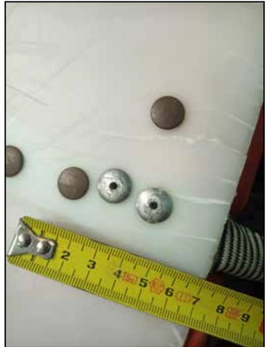
Detalle de microfisuración perimetral, con afectación a la zona de implantación de los remaches. Proceso inicial.
