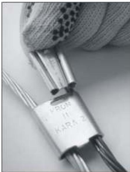
**Paso 4:** caso los componentes C y cuña aún mantengan presión entre ellos, podrán ser liberados con pequeñas batidas en la parte frontal de la cuña, o ajustándose el alicates en un nuevo reglaje que apoque la distancia entre las mordazas, volviendo al Paso 2, y buscando no forzar los dos dientes de la mordaza superior contra el conector, formando una palanca.
