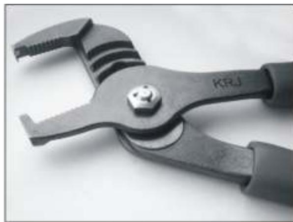
El diferencial del alicates está en el número de reglajes de apertura, y sistema que permite la desconexión de los conectores ramal KARA, cuando de tareas que obliguen la realización de esas desconexiones.
