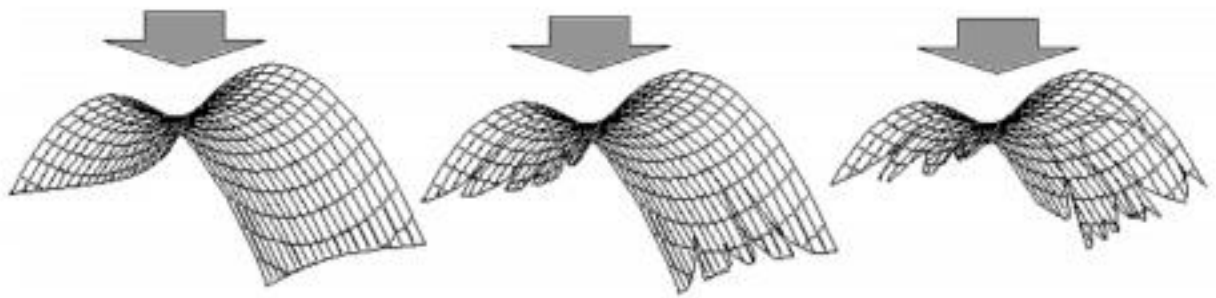
Representación de la rotura de una superficie alabeada al someterse a esfuerzos de compresión. Fuente: Ramón J, Zoido Zamora. Curvas y superficies en la arquitectura
