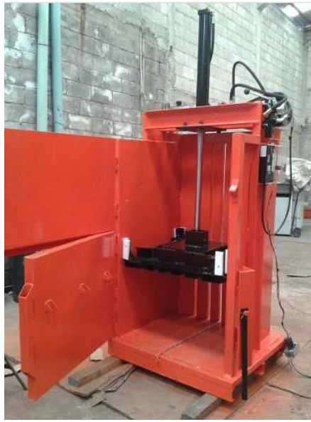
Figura 9. Compactador de Cartón y Plástico
