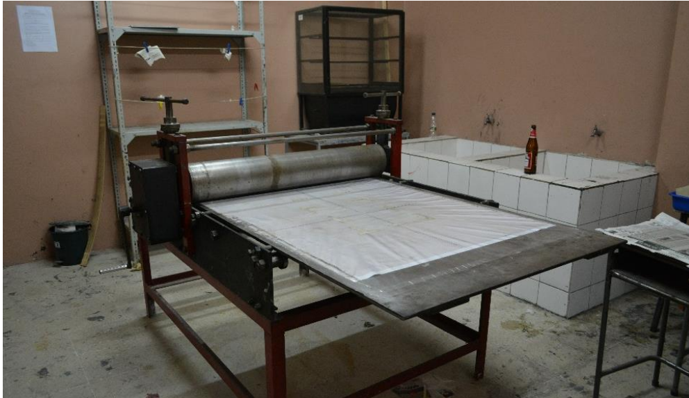
Fig.32. Efrén Guamán (2016) taller de grabado- tórculo o prensa[ fotografía] Loja-Ecuador
