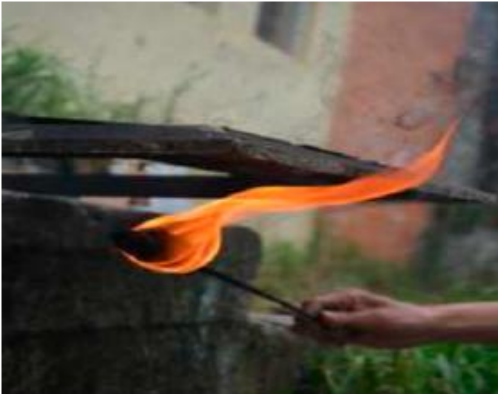
Fig.31. Efrén Guamán (2015) calentando la plancha de tol negro con antorcha y gasolina [fotografía] Loja-Ecuador
