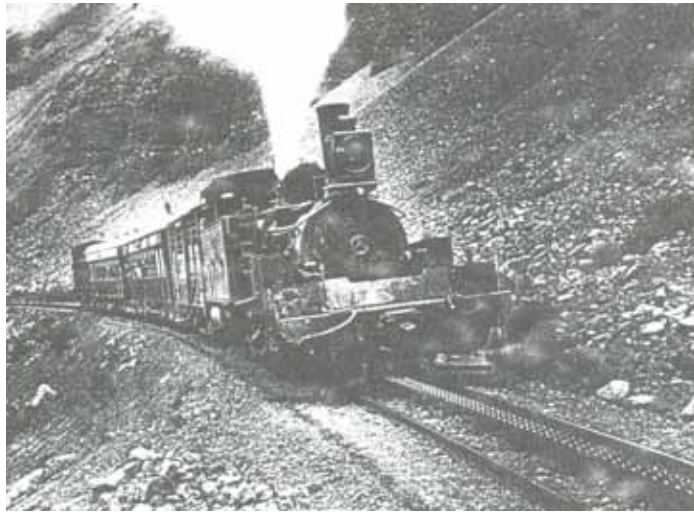
Locomotora Kitson Meyer remonta cuesta con cremallera.
