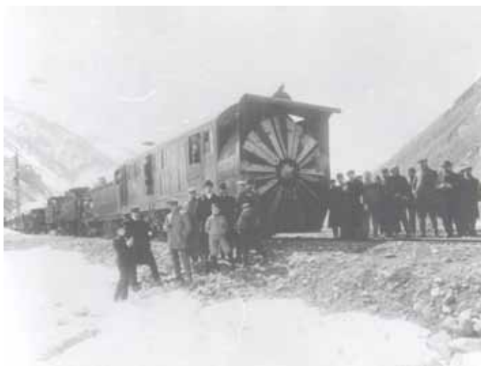
El Rotario, equipo especial para despejar las vías de la nieve.
