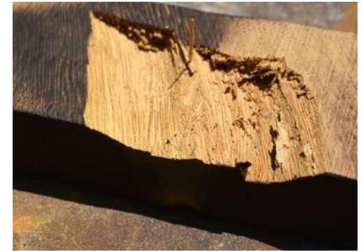
Madera de iroko con fibras partidas mediante presión
