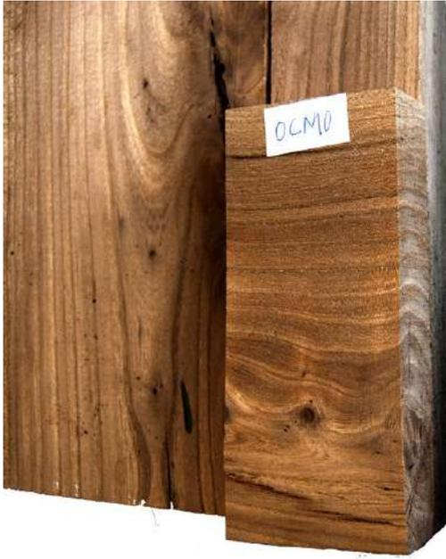
Secciones de madera de olmo
