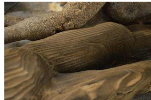
Madera de pino tallada y quemada superficialmente en primer plano y madera aglomerada, fabricada a partir de moldes y resina al fondo
