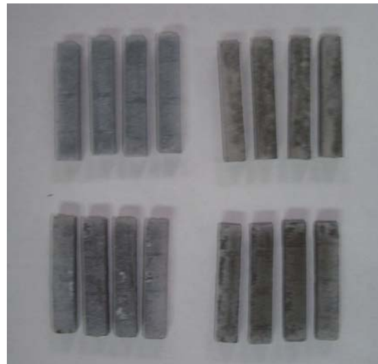
Figura 3.- Aspecto de las probetas según la metodología de Koch & Steinegger.
