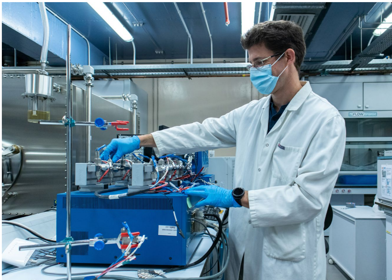
El investigador del ICMAB-CSIC, Alexandre Ponrouch, manipulando una celda electroquímica en un potenciostato. / ARTUR MARTÍNEZ
