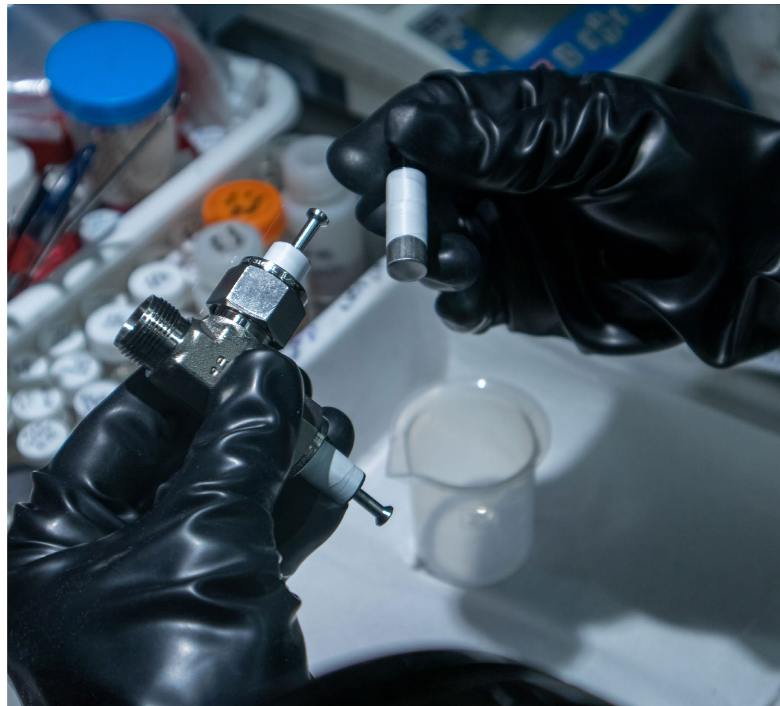
El investigador del ICMA-B-CSIC, Alexandre Ponrouch, manipulando una celda electroquímica en una caja de guantes en atmósfera inerte. / A. M.
