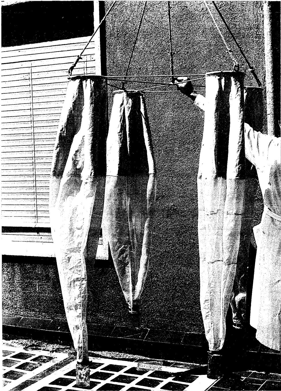
Fig. 2.- Mangas troncocónicas montadas en un mismo soporte y provistas de conos filtrantes de diferentes tamaños de malla.
