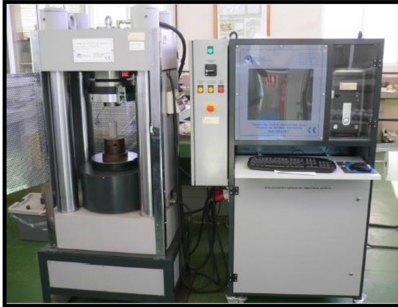
Figura 4 Equipo para elaborar el ensayo a compresión simple *cortesía de (Hernández, 2013)*
