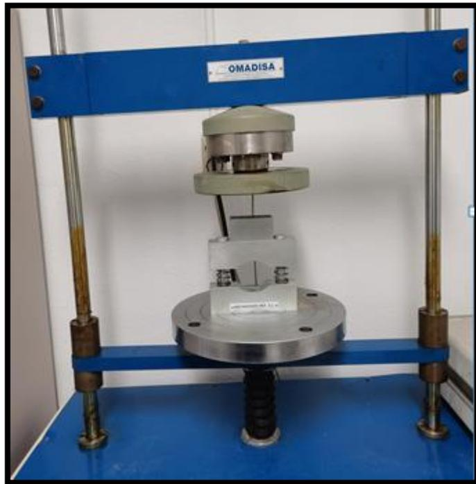
Figura 5 Equipo utilizado para el ensayo de resistencia a tracción indirecta (ensayo brasileño), *Cortesía de Prof. Vicente Gómez Ruiz de Argandoña.*
