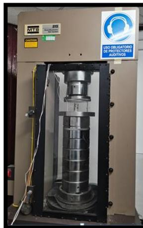
Figura 6 Equipo para el desarrollo del ensayo triaxial en rocas- célula Hoek, con medición de micro-deformaciones mediante bandas extensométricas *cortesía de Prof. Vicente Gómez Ruiz de Argandoña.*
