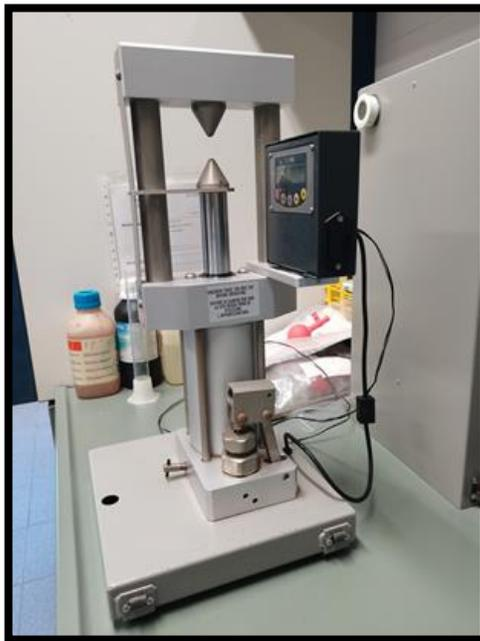
Figura 7 Equipo utilizado para realizar el ensayo a carga puntual *cortesía de Prof. Vicente Gómez Ruiz de Argandoña.*
