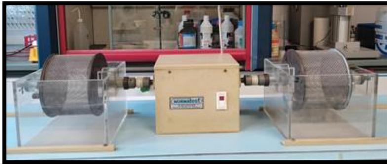
Figura 9 Equipo para desarrollar el ensayo de slake durability test *cortesía de Prof. Vicente Gómez Ruiz de Argandoña.*
