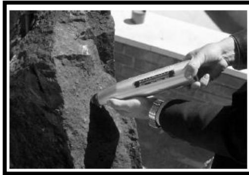
Figura 12 Martillo de Schmidt tipo I o esclerómetro en campo (Ramirez Oyangüren, 2004)
