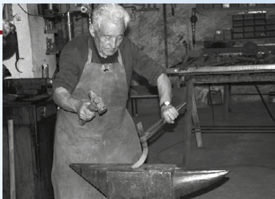
En la fragua, además de fabricar útiles de hierro, se aguzaban rejas y rejanchos.
